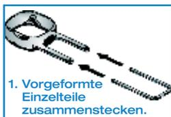
1. Vorgeformte Einzelteile zusammenstecken.
